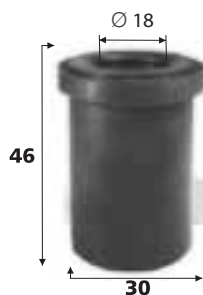
Buje goma gemelo de Elástico Modelo: Toyota Hilux 4x4 Código: 440 Código Original: 90385-15016
