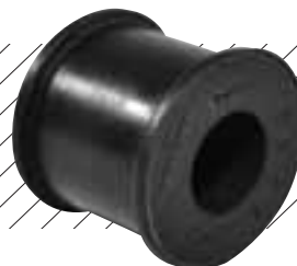
156-A Buje de Bieleta Barra Estabilizadora Delantera / Stabilizer bar bushing
