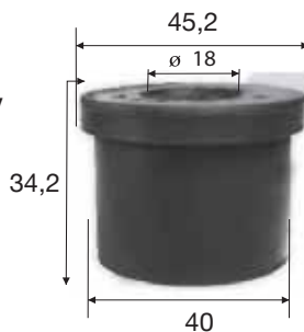
Buje elástico trasero parte trasera Modelo: Isuzu KB / Chevrolet Luv Código: 433
